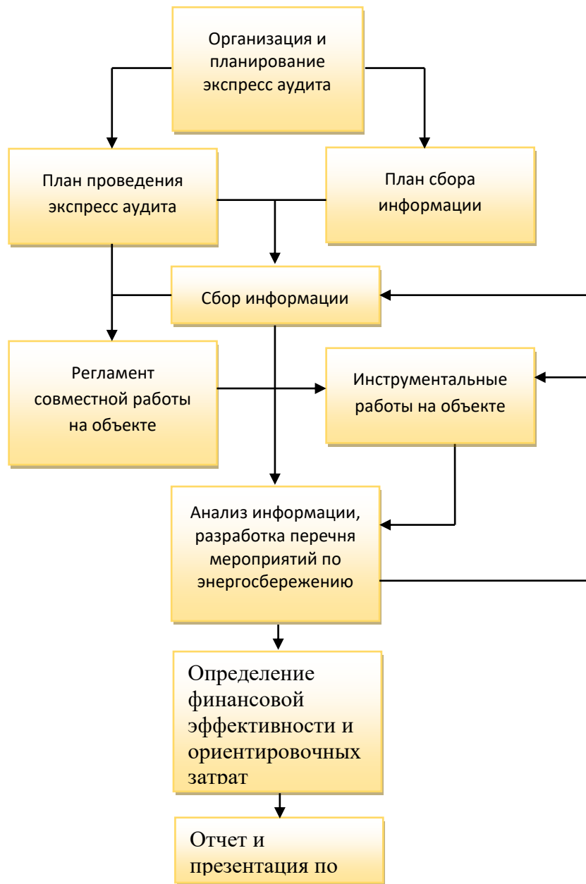
Рис. 2 Блок-схема проведения экспресс-аудита электродвигателей
