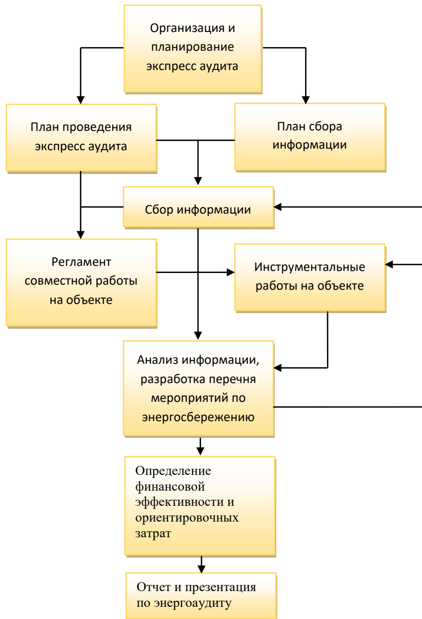
Рисунок 2 Блок-схема проведения экспресс-аудита трансформаторных подстанций
